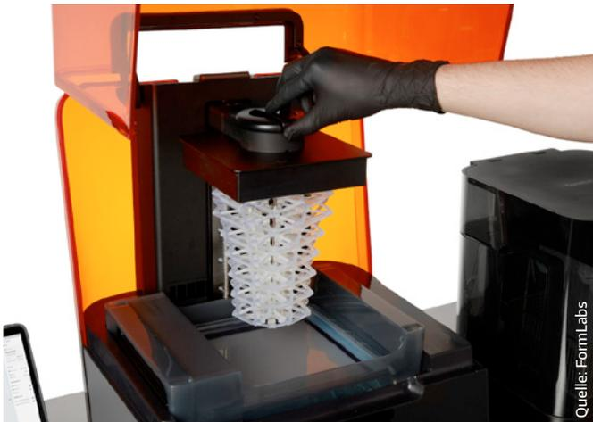
Bauteilentnahme aus Flüssigharzdrucker
