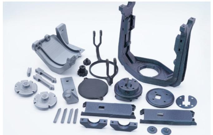
Prototypenfertigung durch 3D Druck
